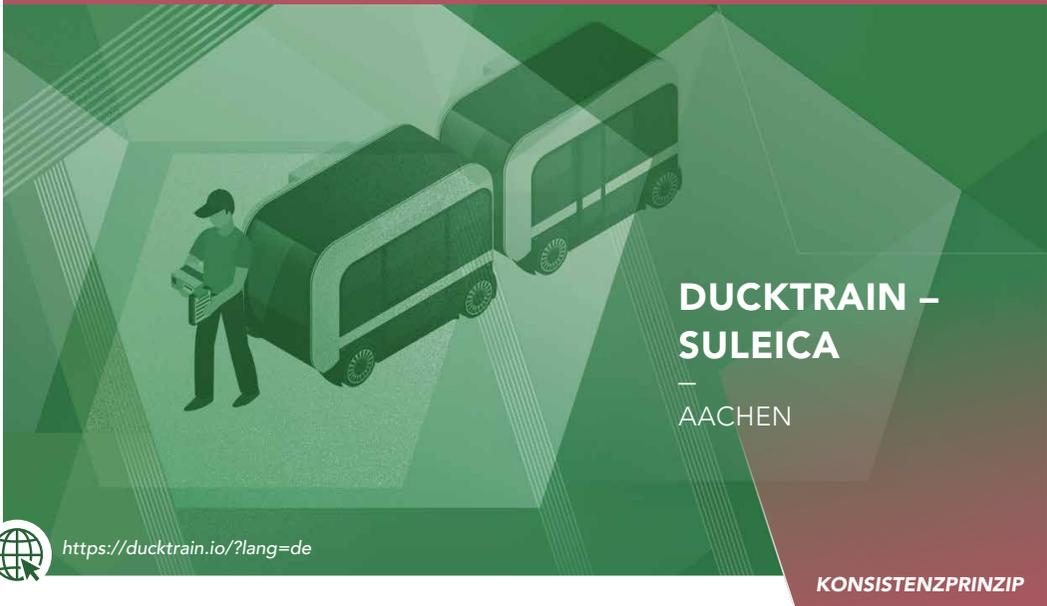
Das **Ducktrain-Konzept** setzt automatisierte, fahrerlose Lastenanhänger für Lieferdienste ein und koppelt diese zu einem Routenzug. Dieses Modell **erhöht das Liefervolumen signifikant** um mehrere hundert Kilo.
